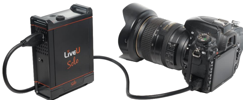
図 42: HDMI でカメラに接続された LiveU Solo
