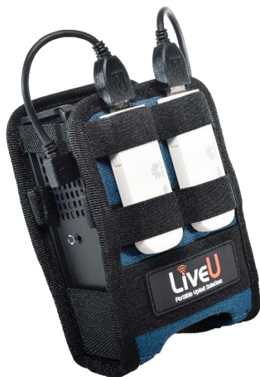
図 43: LiveU Solo - 外付けモデムの固定と接続
