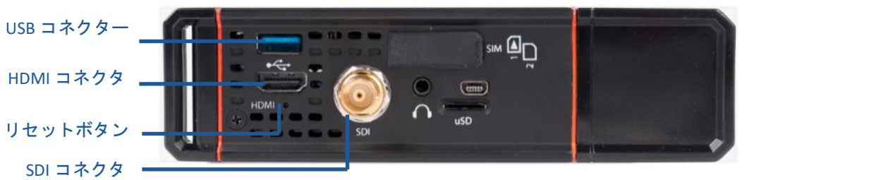
図 3: 右側面 - LiveU Solo (SDI/HDMI) & Solo Plus
