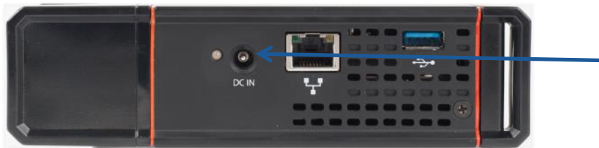
図 39: DC IN コネクタ (Solo, Solo Plus)
